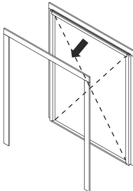
3. Закрепить коробку в проеме на 2 самореза 4,5×90 мм
