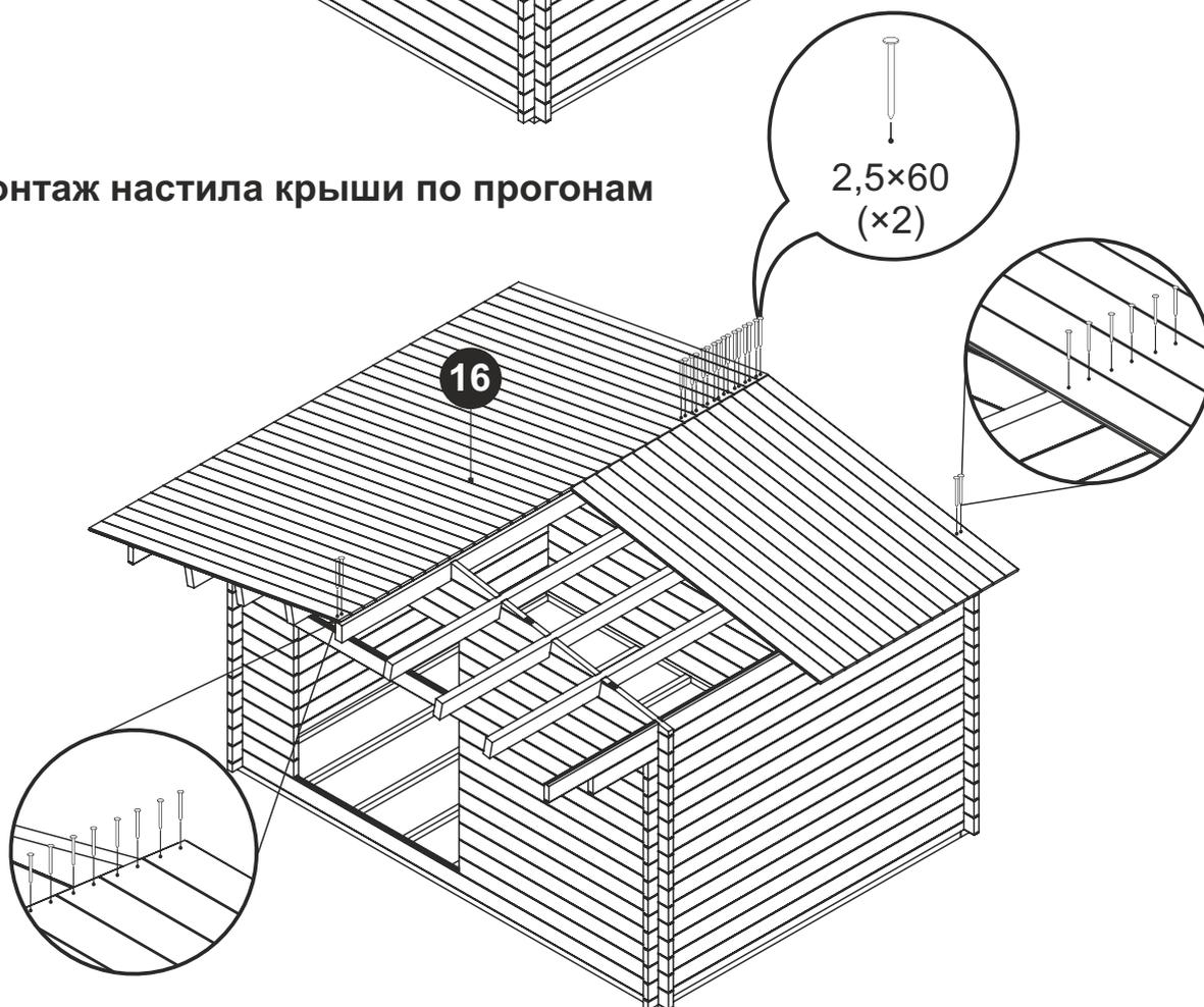
Крепление досок настила крыши выполняется на 2 гвоздя в местах опирания на прогоны и стены. Перед установкой стартовой детали навеса необходимо срезать шип (гребень) по всей длине. В случае необходимости последние детали настила следует обрезать по месту по всей длине.
