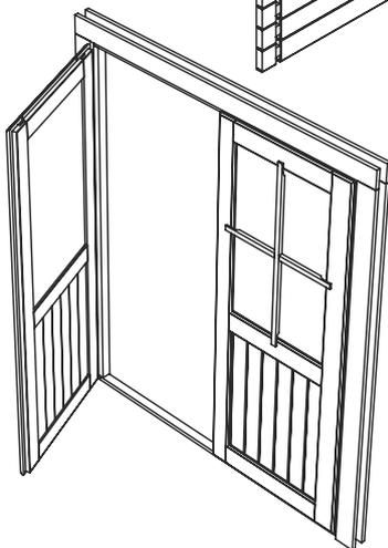
Перед закреплением дверных и оконных блоков следует выставить их по уровню. Для установки окон и одностворчатых дверей повторите пункты 2,3,4 из инструкции по монтажу двухстворчатых дверей.
