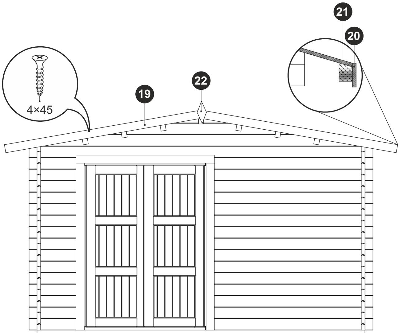
Закрепить по периметру крыши лобовые доски карнизных свесов при помощи саморезов 4×45 мм. Шаг установки саморезов по длине деталей 20 и 21 не менее 500 мм. Установить элементы декора 22. Детали 19, 20, 21 подрезать по месту при необходимости.
